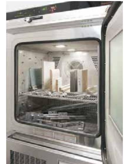
Mit einem sogenannten Gitterschnitt prüfen wir, in wie weit die Lackbeschichtung auf die Temperaturunterschiede reagiert.
