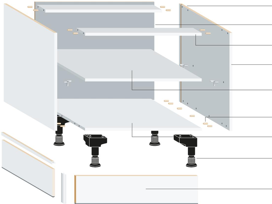
Seitenwände 16 mm stark,
