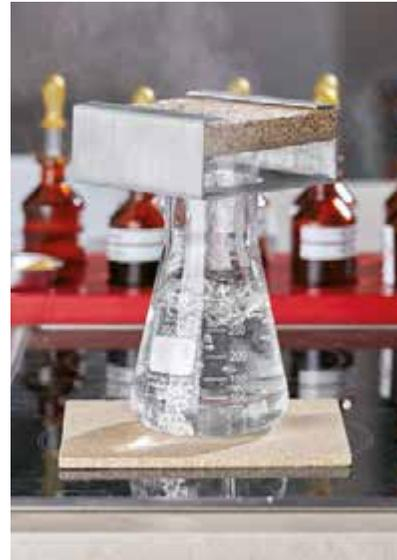
Die dekorative Oberfläche von Arbeitsplatten wird 1 Stunde lang direktem Wasserdampf über siedendem Wasser ausgesetzt. Farbveränderungen und Oberflächenschäden sind nicht zulässig.
